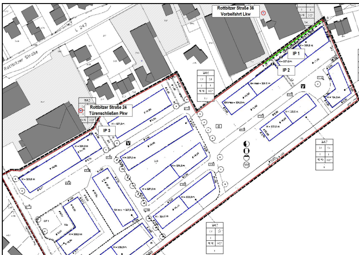
Abb. 4.4.1 Lage der Immissionspunkte und der Punktquellen zur Berücksichtigung der Spitzenpegelsituation
