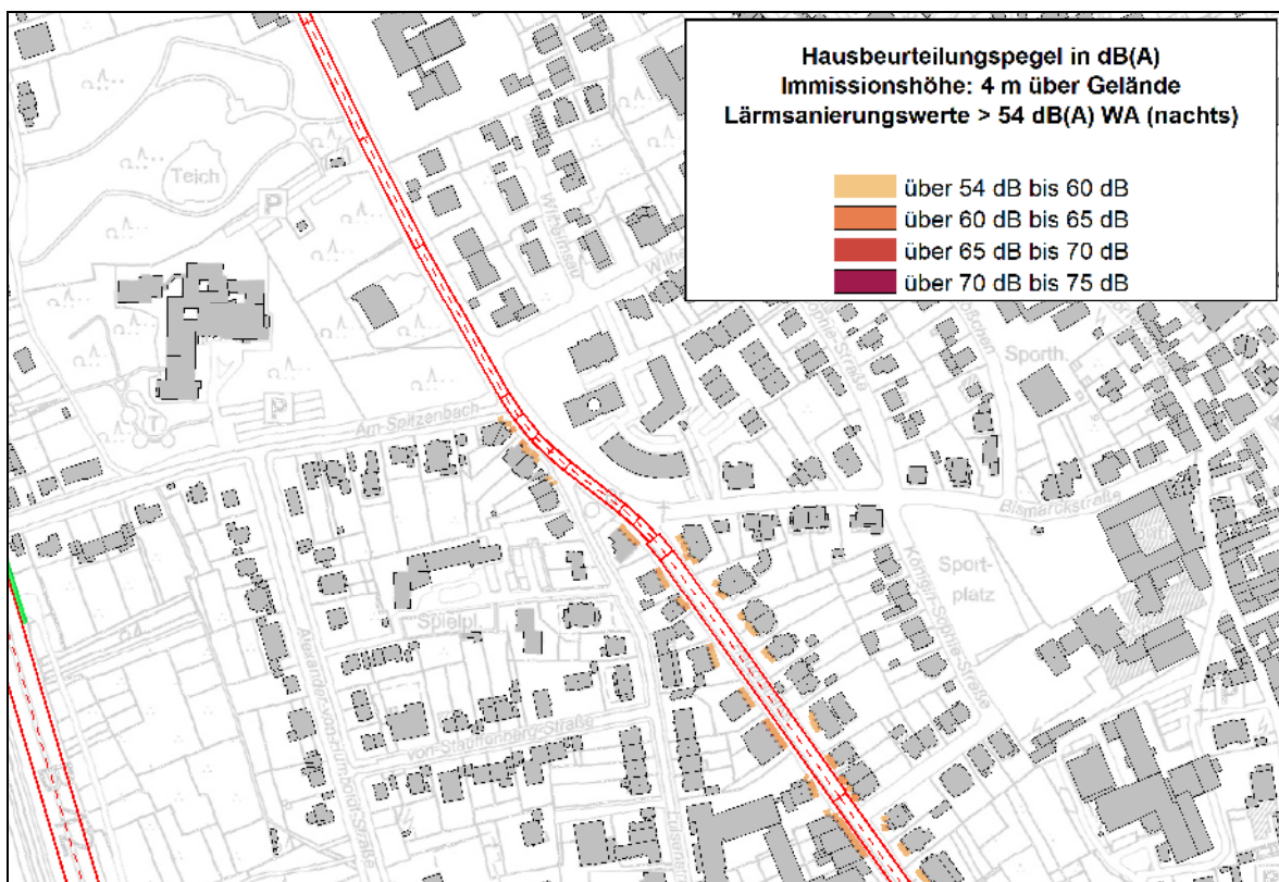
Abb. 11.5.38 Beurteilungspegel nachts ab 54 dB(A) unter Berücksichtigung der maximal zulässigen Geschwindigkeiten von 30 km/h auf der Rhöndorfer Straße bzw. der Hauptstraße“ im Bereich der Hauptstraße (RLS-19)
