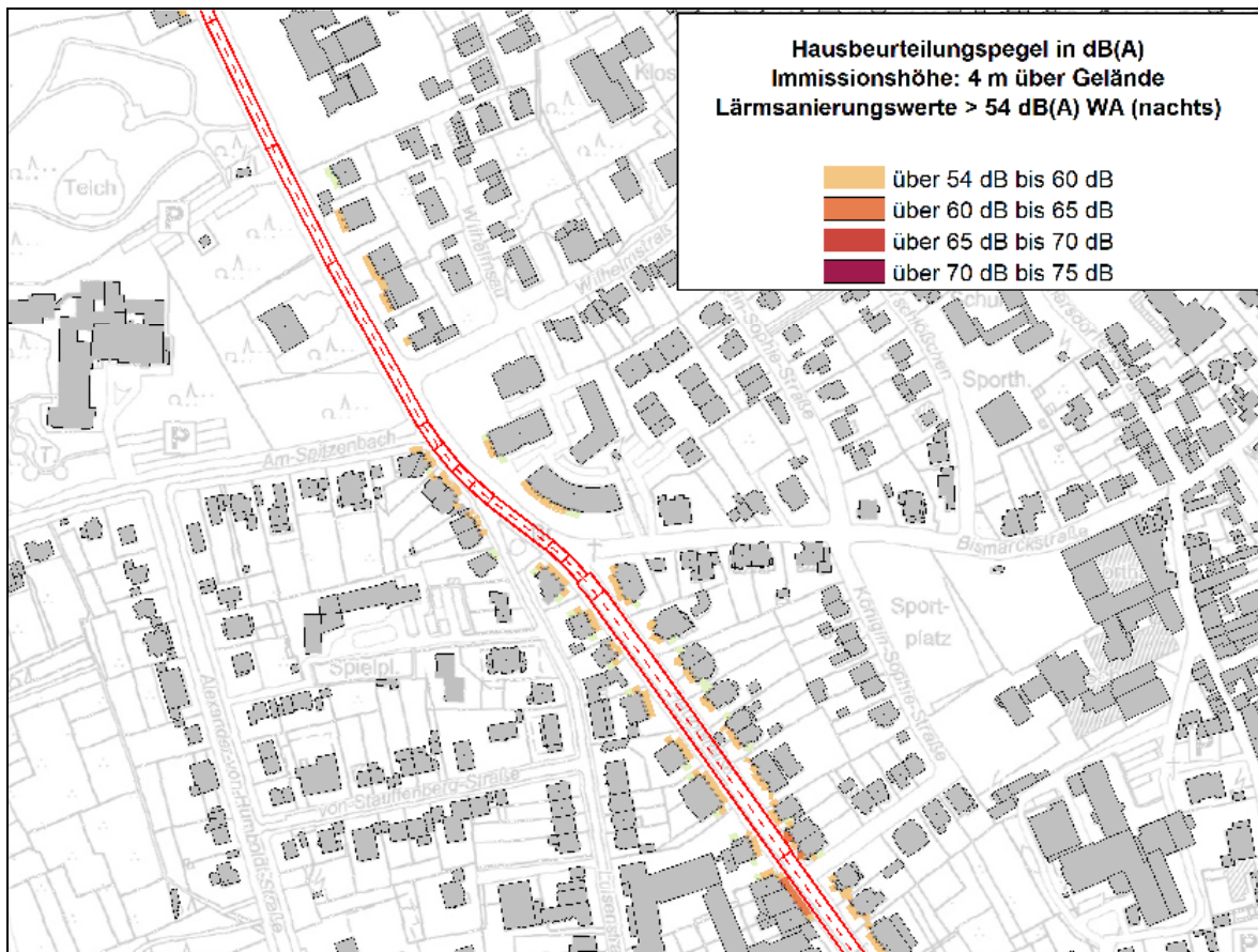
Abb. 11.5.37 Beurteilungspegel nachts ab 54 dB(A) unter Berücksichtigung der derzeitigen Geschwindigkeiten im Bereich der Hauptstraße (RLS-19)
